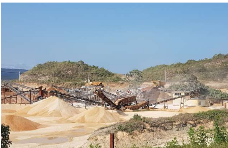
Fig. 2.1 Molino español, con una capacidad de producción de 100\ 000\ m^3 de áridos al año.
