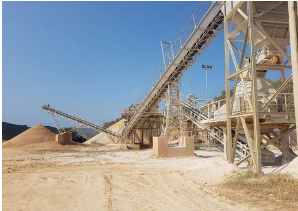
Fig. 2.2 Molino italiano con capacidad de producir 200 000 m 3 de áridos al año. Fuente: El autor
