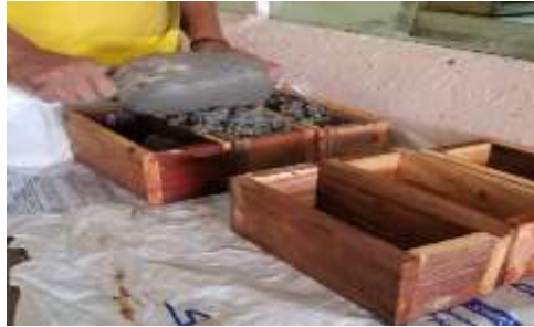
Fig.2.5 Llenado de los moldes.
