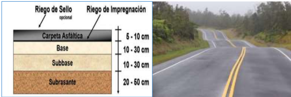
Fig.1.7 Pavimento flexible (Google).
