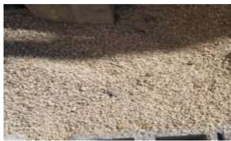
Fig.2.2 Granito (árido grueso).
