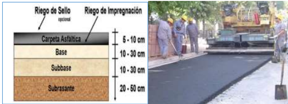
Fig.1.8 Pavimento semi-rígido (Google).
