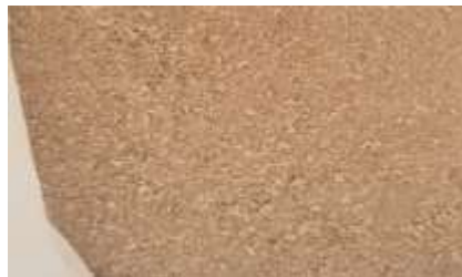
Fig.2.4 Árido obtenido mediante la trituración del residuo prefabricado
