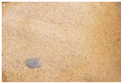
Fig.2.3 Muestra de Arena artificial (árido fino)
