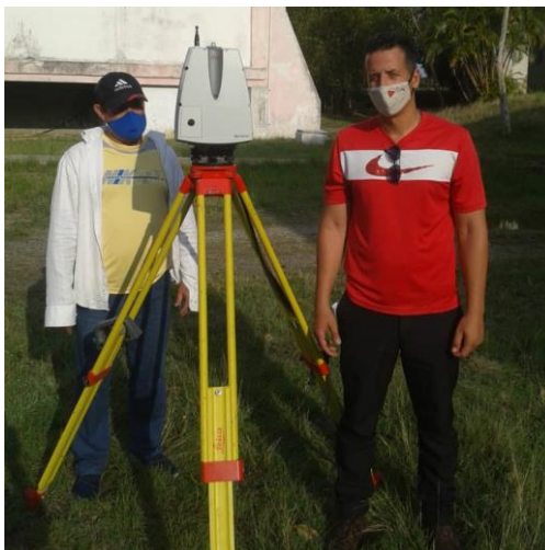
Figura 2.6: ELT P40 y sus operarios. (Autor)
