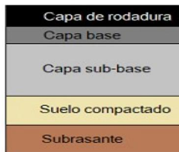
Figura 1.1 Estructura general de un pavimento
