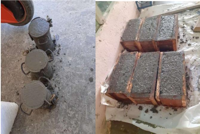
Figura 2.1 Probetas cilíndricas y adocretos
