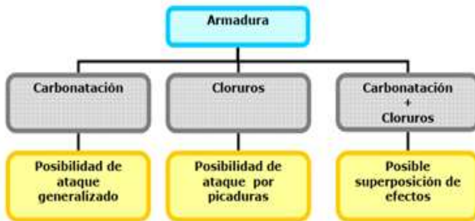
Figura 1.2: Tipos de corrosión en la armadura.
