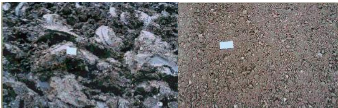
Foto 1.2 Suelo tratado con cal, antes y después del mejoramiento. 6
