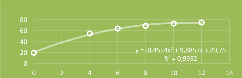
Gráfico 2.4 Incremento de CBR con la adición de cemento P250 al 4,6,8,10 y 12%. 26
