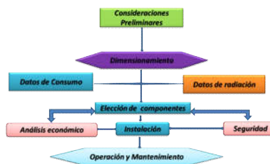
Figura 2.8. Diagrama de flujo del dimensionamiento.
