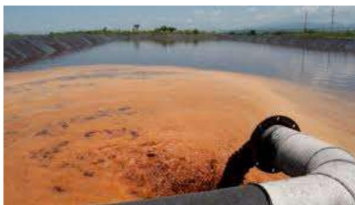
Figura 1.7 Vertimiento de las vinazas en lagunas de oxidación.
