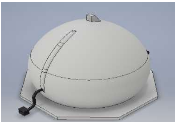
Figura 2.14 Gasómetro esférico de doble membrana plástica. Fuente: Vitoria Gasteiz.SA
