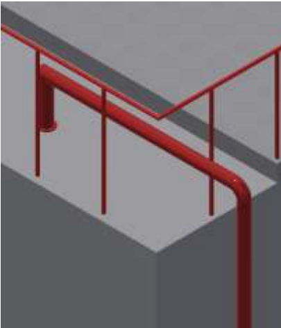
Figura 3.18. Tubería de biogás del Reactor UASB de postratamiento.
