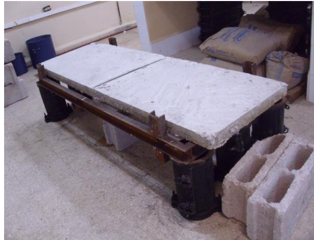
Figura 2.1 Fotos del bastidor durante la nivelación y soportando la losa respectivamente.
