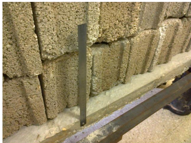
Figura 2.2 Nivel topográfico y regla usados en la medición de las deflexiones.
