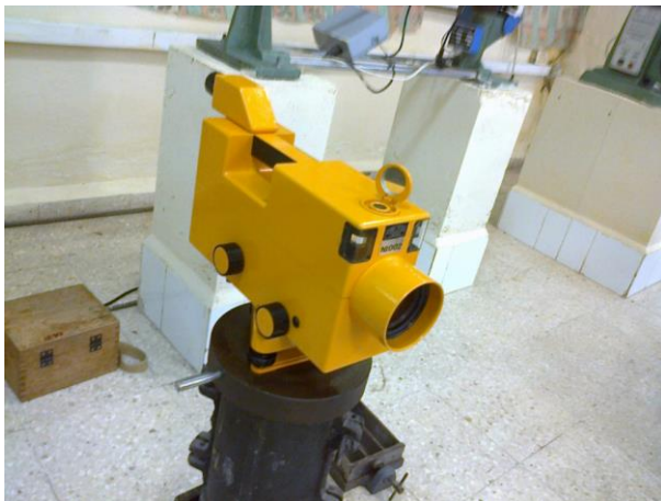
Figura 2.2 Nivel topográfico y regla usados en la medición de las deflexiones.
