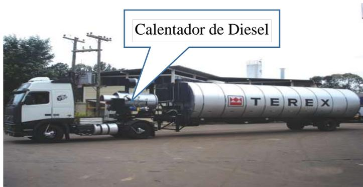
*Figura 2.17. Paila para el traslado del betún asfáltico*
