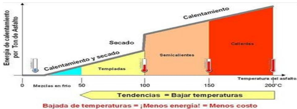
Figura 1.3: Comportamiento Temperatura del asfalto VS Energía de calentamiento.
