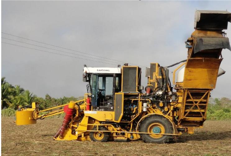
Figura 1.1. Máquina cosechadora cañera modelo
