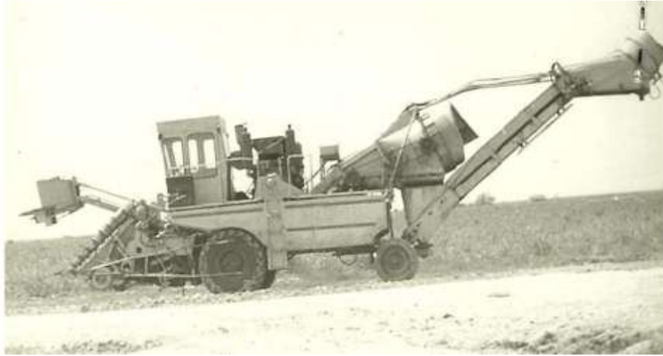
Figura 1.3: Cosechadora de caña de azúcar KTP-2.(Ricardo, 2011)
