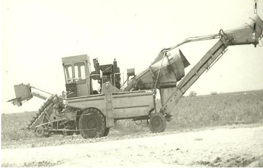
Figura 1.3: Cosechadora de caña de azúcar KTP-2. Fuente: Max (Archivo personal).
