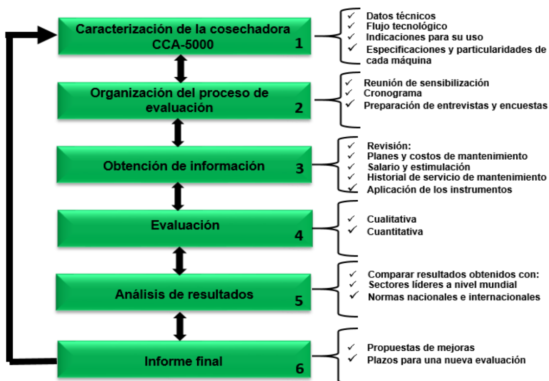
Figura 2.4: Metodología propuesta para la evaluación de la calidad del sistema de mantenimiento en las cosechadoras de caña CCA-5000
