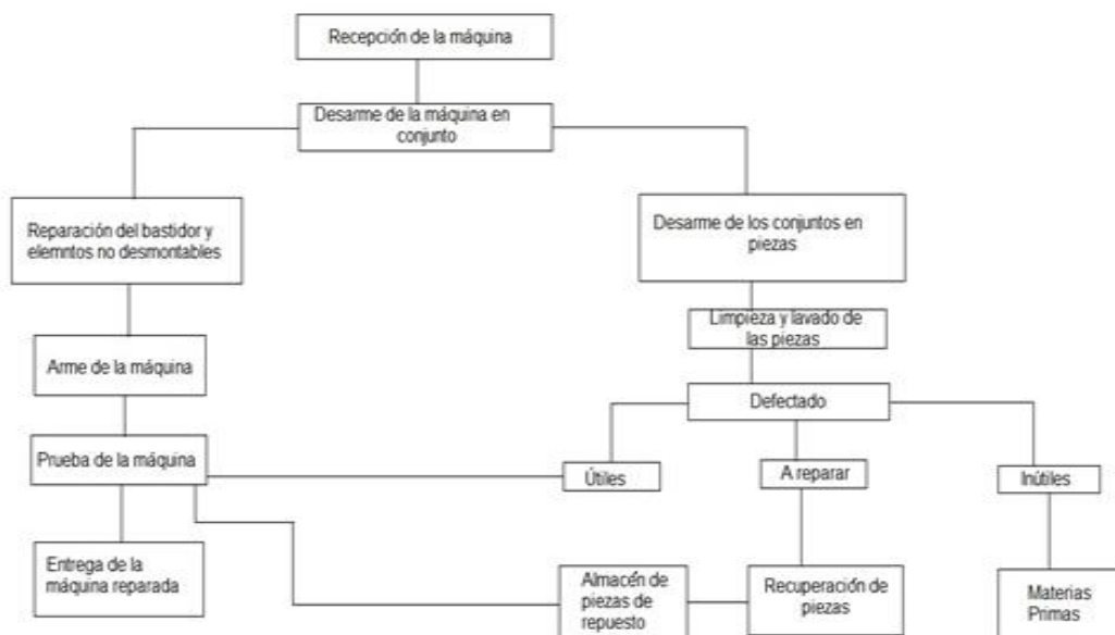
Figura 2.2: Esquema del proceso tecnológico empleado en la reparación. Fuente: Raúl Atá, (1974).
