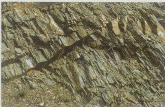
Pizarras ordovícicas. Calidad media. Grado de fracturación alto. Grado de meorización: III.
