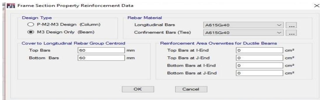
Figura II.36: Detalle del recubrimiento de la viga de entrepiso V-3, V-4 y V-5.
