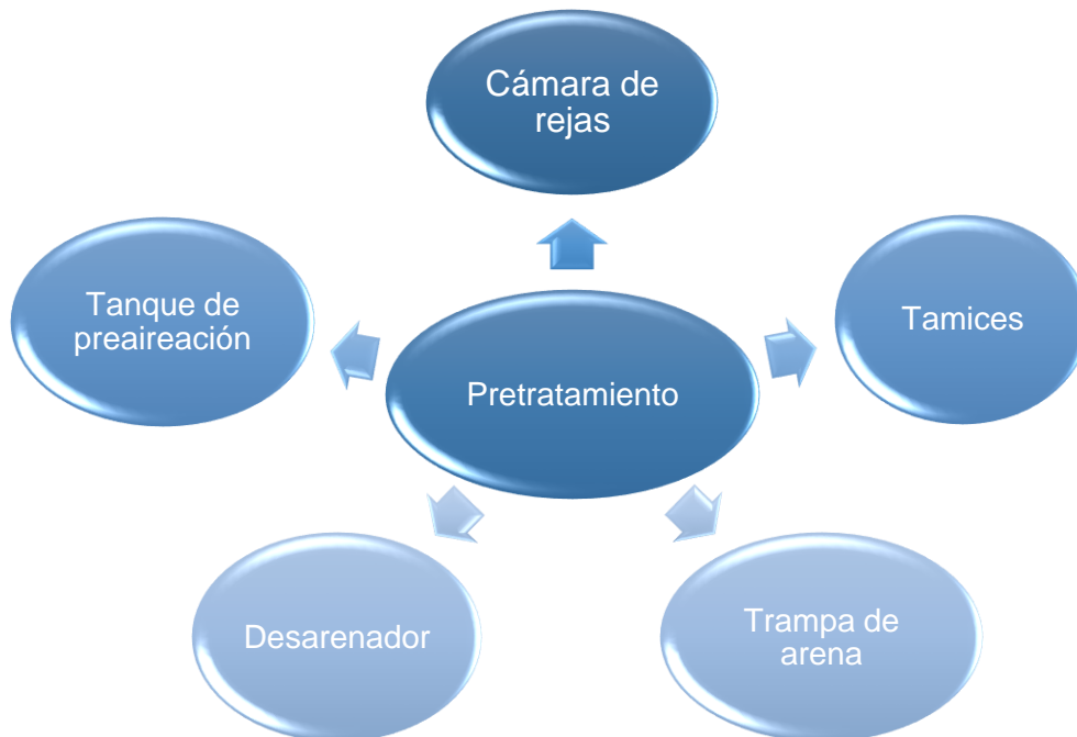
Figura – 5: Sistema de Pretratamiento
