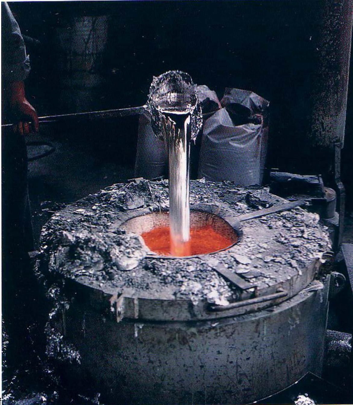
Fig.9 Conducción de la colada cuando el metal es colocado en los moldes
