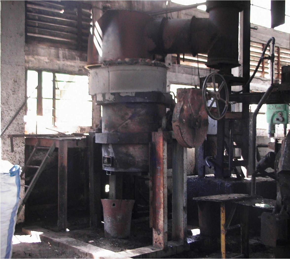
Fig. 10 Horno para fundir los metales de la aleación.
