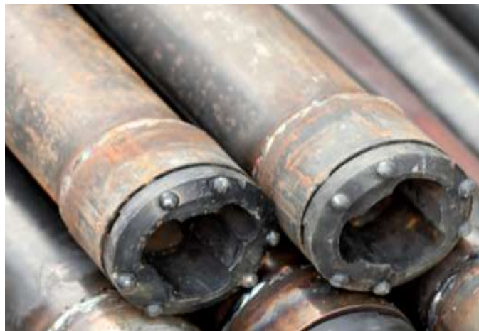
Figura 4 Sistema P89 armadura de acero de diámetro 88,9 mm. Fuente (Minería, 2011)
