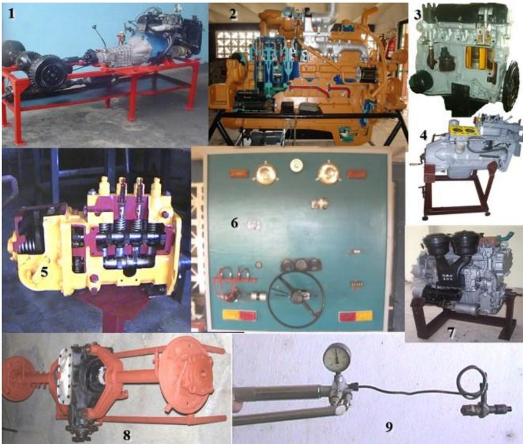
Fig. 3. Medios de enseñanza contruidos (1. Banco de motor y transmisión Lada, 2. Maqueta de motor Komatsu, 3. Maqueta del motor Lada 2101, 4. Maqueta del motor ARO, Maqueta de bomba de inyección, 6. Maqueta del sistema eléctrico del automóvil clásico, 7. Motor de dos tiempos MAZ 2008. 8. Puente propulsor y suspensión independiente de Skoda, 9. Comprobador manual de inyectores).
