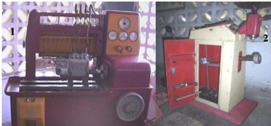
Fig. 4. Máquinas recuperadas (1. Máquina para el calibrado de bombas de combustible de alta presión e inyectores, 2. Balanceadora de neumáticos).
