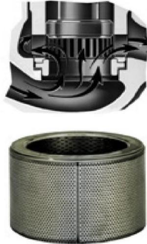
Fig. 15 Diseño de internos de válvula para la reducción de ruido
