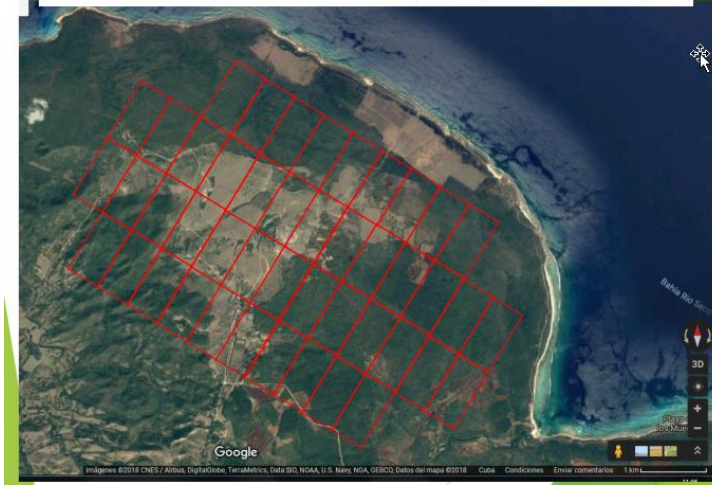
Río Seco 6,7 m/s FC=27% (63*2,5=157,5 MW)
