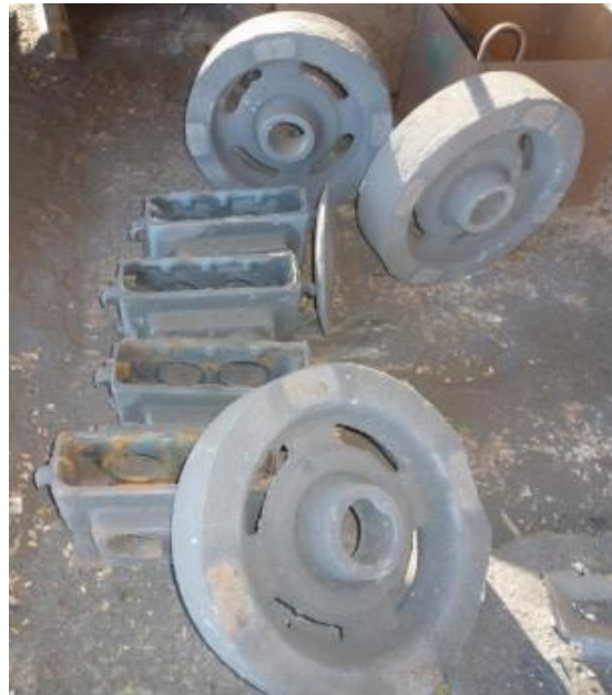
Fig 2.3 Piezas fundidas después de la limpieza
