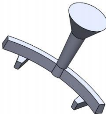
Fig. 2.7. Sistema de alimentación del fundido del crisol termo resistente.
