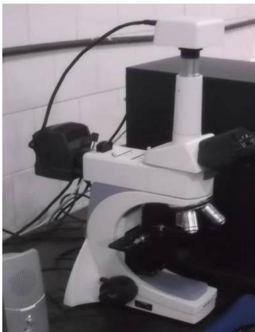
Figura 2.8. [Fotografía de Ramón Alvarez Aguilera]. (Universidad de Holguín. 2021). Microscopio metalográfico. Cuba.
