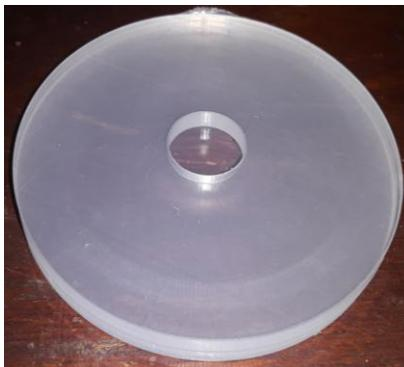
Figura 2.11. [Fotografía de Ramón Alvarez Aguilera]. (Universidad de Holguín. 2021). Lámina de acrílico 2, prueba de consistencia. Cuba.
