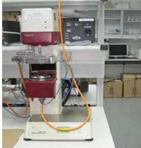
Figura 1.1. Reómetro de esfuerzo controlado RS-150.
