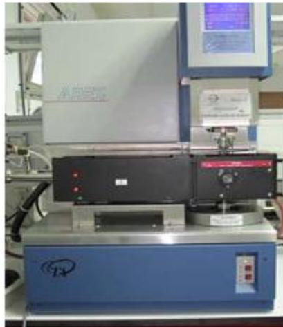
Figura 1.3. Reómetro de deformación controlada ARES.
