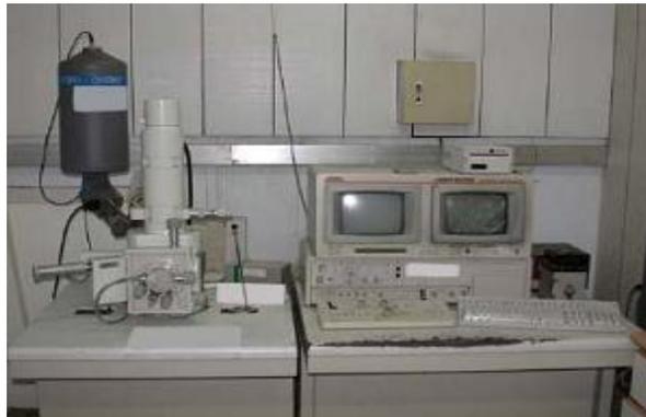
Figura 1.5. SEM modelo JSM -5410.
