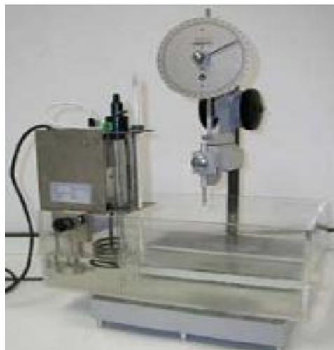
Figura 1.6. Penetrómetro modelo Seta Universal Penetrometer 17000-2
