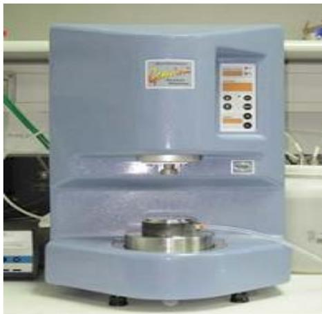
Figura 1.2. Reómetro de esfuerzo controlado Gemini BOHLIN.
