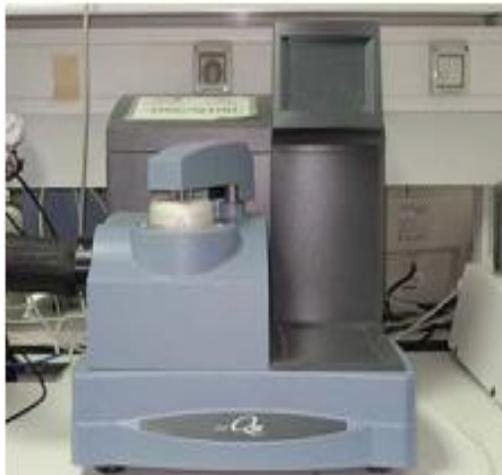
Figura 1.8. Calorímetro diferencial de barrido (DSC Q-100).
