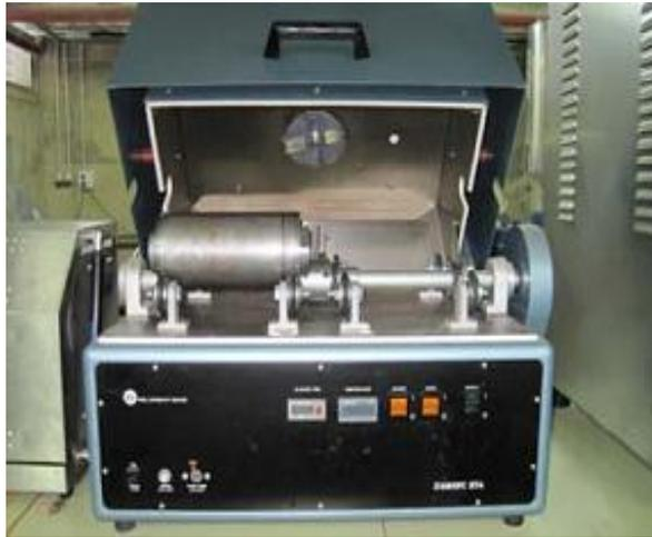
Figura 1.7. Roll Stability Tester modelo 1940-3
