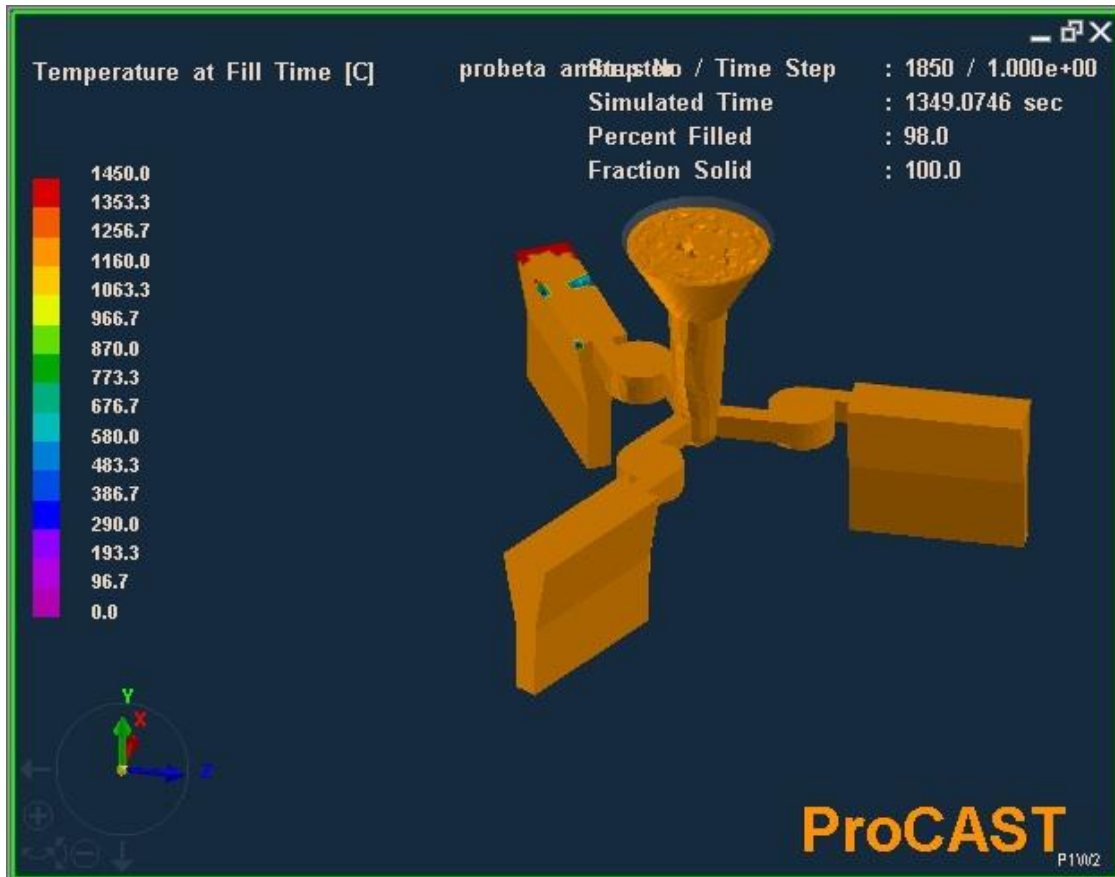
Figura 17 Análisis de los efectos superficiales de la orientación del avance del frente de enfriamiento, solidificación y contracción de los moldes de hierro gris con grafito nodular esférico elaborados con mezclas carburante. Fuente de elaboración: Propia.
