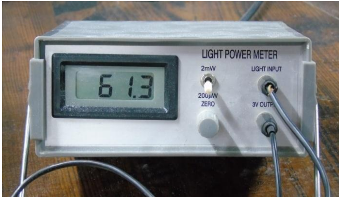
Fig. 2- Medidor de potencia de luz. Fuente: Elaboración propia.
