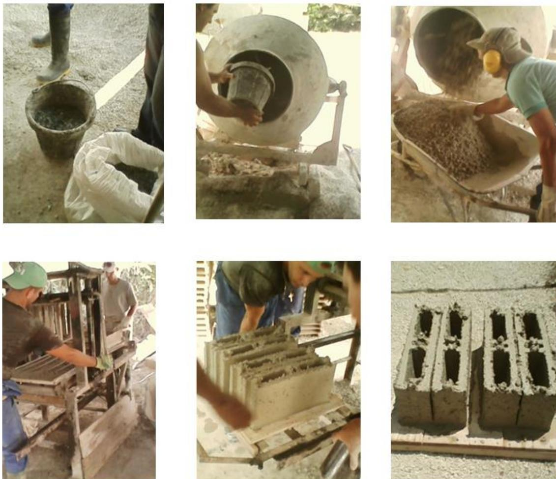
Figura 5.2 Elaboración de bloques huecos de hormigón.
