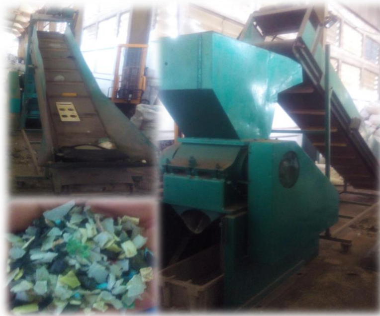
Figura 2.4 Molino de la empresa de materias primas y una muestra de PEAD triturado. Fuente: Elaboración propia.
