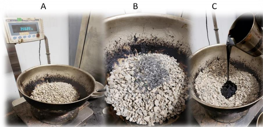
Figura 1.5 Método seco. A: agregado utilizado para la mezcla, B: inclusión del plástico, C: asfalto vertido en la mezcla. Fuente: Monturiol, M., 2019.
