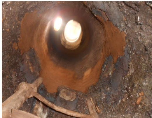
Fig. 2.2 Vista inferior interior del horno de cubilote HC – 720 mm
