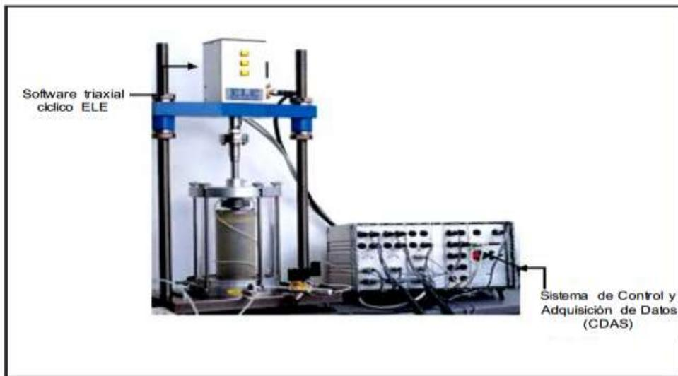
*Fig.: 5. Conjunto de ensayo triaxial cíclico para el control y medición de la carga aplicada. Fuente:(Sanches, 2009).*
