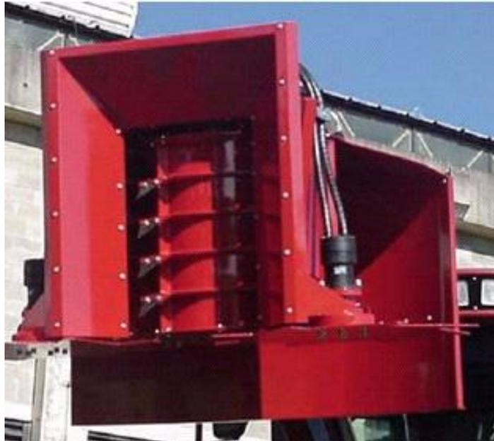
Figura 1.9. Cortacogollo desfibrador en cosechadora cañera CASE. Fuente: Manual de explotación combinada cañera CASE (2006)
