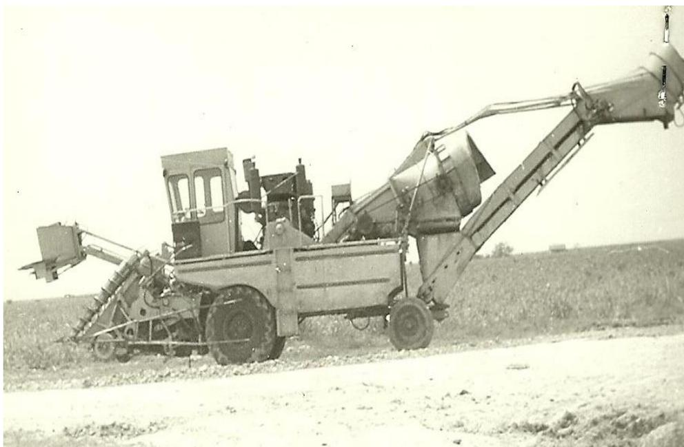
Figura 1.10. Cosechadora cañera prototipo KTP-2, diseñada en la URSS y construida en Cuba. Fuente: Max (Archivo personal)
