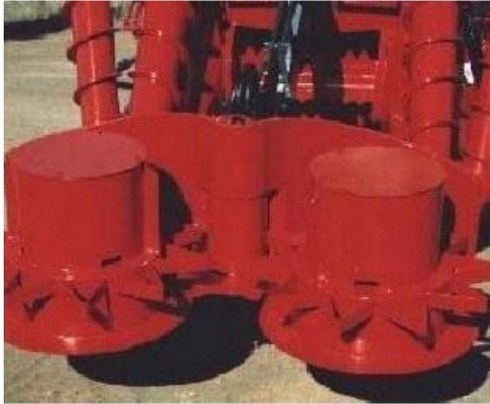
Figura 1.8. Cortacogollo convencional en cosechadora cañera CASE. Fuente: Manual de explotación combinada cañera CASE (2006)
