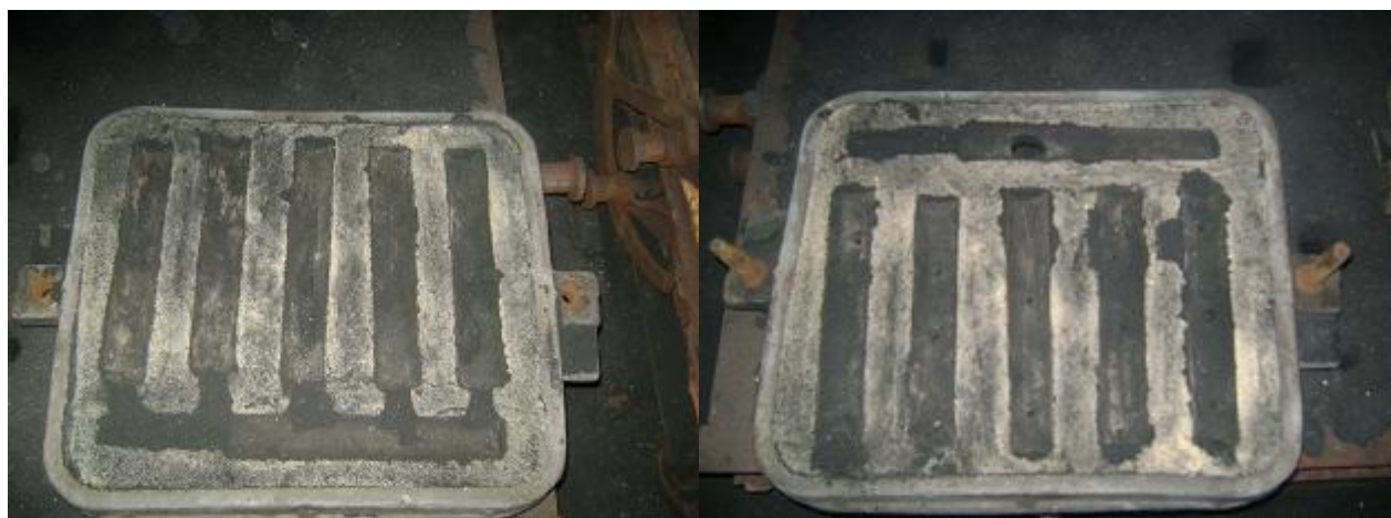
Figura 7. Molde para la demostración empírica. Izquierda: Caja inferior. Derecha: Caja superior.
