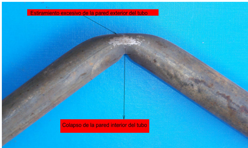
Fig.12, Tubo una vez doblado. Colapso de la pared interior, estiramiento excesivo pared exterior.
