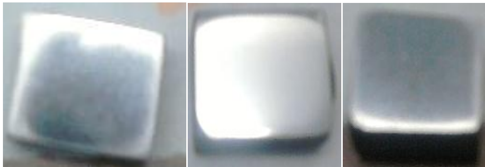
Fig. 2.5 Probetas pulidas con lijas de granos desde 150 mm hasta 800 mm para su estudio metalográfico.
