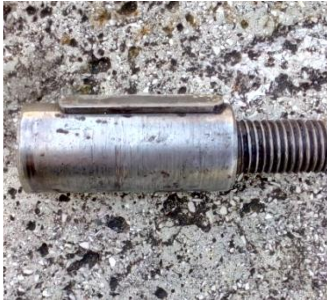
Figura 1.17 Sección del árbol fracturada que ensambla con el núcleo de la rueda
