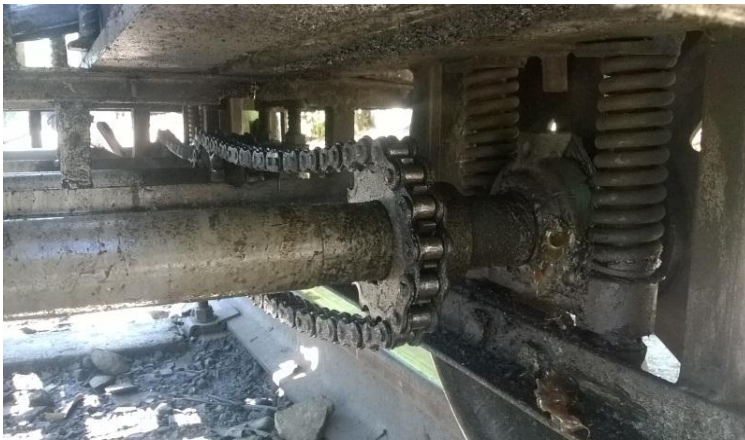
Figura 1.15 Transmisión por cadena del autocarril TD5M.
