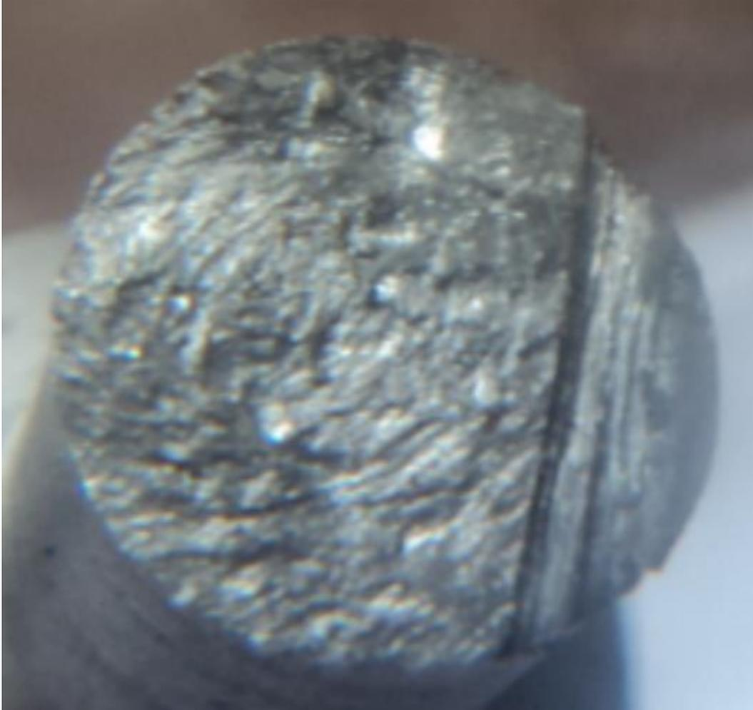
**Figura 2.9** Sección transversal de la rotura de la probeta 2.
