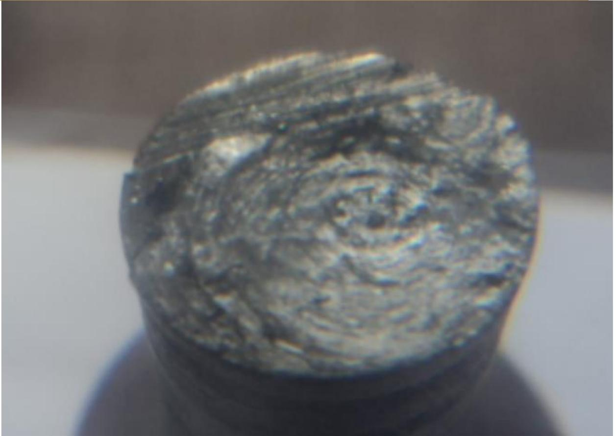
**Figura 2.8** Sección transversal de la rotura de la probeta 1.
