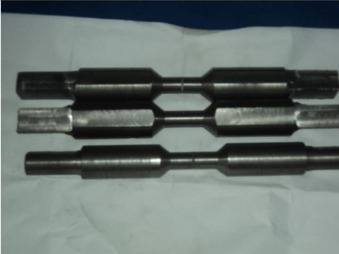
**Figura 2.4** Probetas de acero CT3 para los ensayos.
