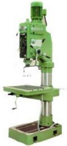
**Fig. 1.11 Taladradoras verticales de columna.**
