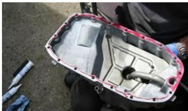
Figura 1.7 Limpieza del cárter. (Fuente:
