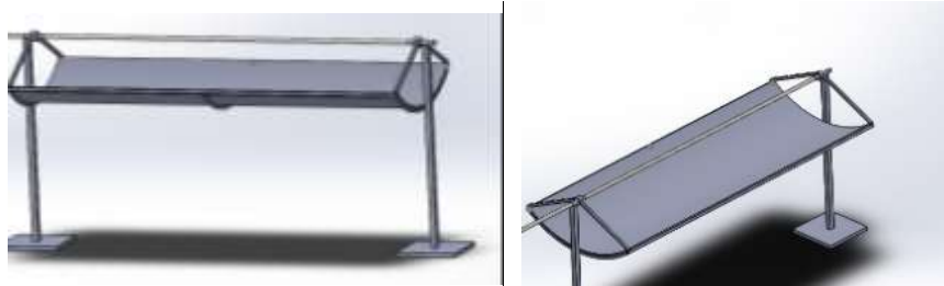
Figura.2.12. Vistas de la estructura de la parábola.
