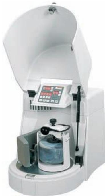
**fig. 1. Molino mono-planetario (año 1995)**
