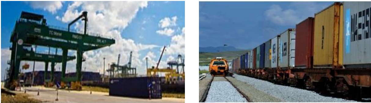
Figura 5: Grúa pórtico sobre riel RMG.
