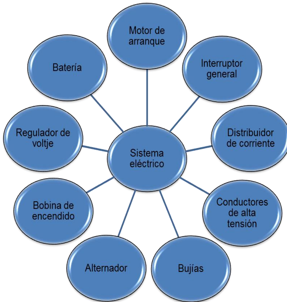
Fig 2.2. Componentes del sistema eléctrico (Elaboración propia).
