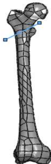
Figura2.7 Fractura subtrocanterea simulada obtenida después del proceso de partido.
