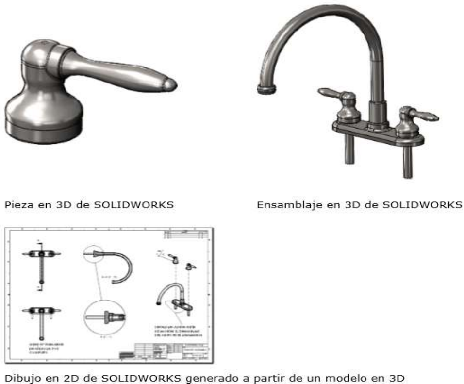
Figura 1.23 Realización de piezas ensambles y croquis en SolidWorks (Dassault Systemes SolidWorks Corporation, 2015).
