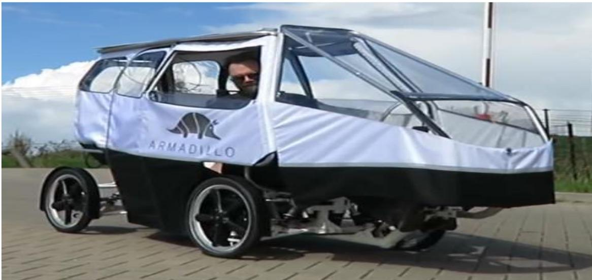
Figura 1.13 Ejemplo de cuadríciclo de pedal asistido biplaza con recubrimiento (ICBF, 2016)
