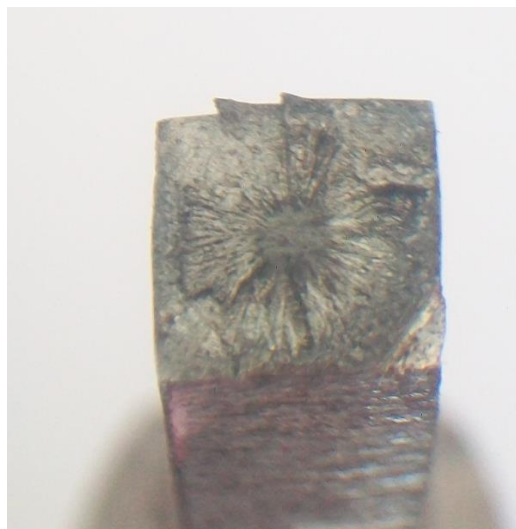
Figura 2.12 Sección transversal de la rotura de la probeta 1.
