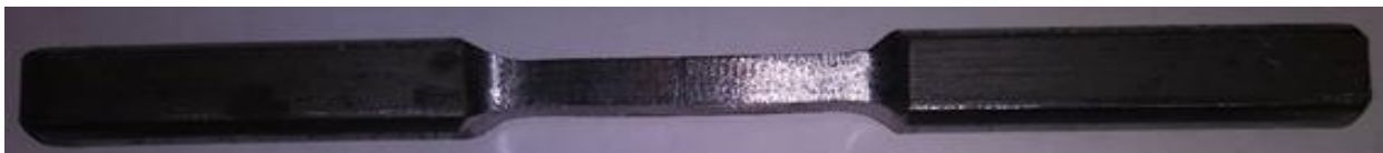
Figura 2.4 Probetas de acero AISI 1015 para los ensayos.
