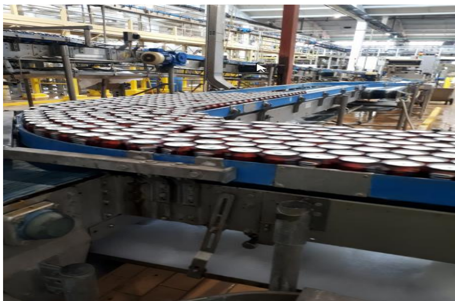
Figura 2.15 Transportadores de latas. Fuente elaboración propia
