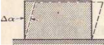
Figura 1.15 Fuerza cortante aplicada a un cuerpo solido ubicado en dos planos
