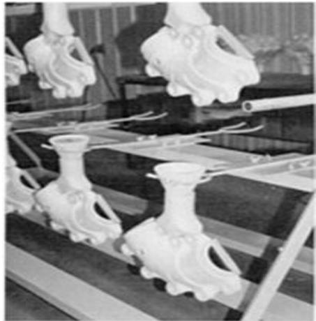
Figura 1.124 Modelo completo de EPS ensamblados listos para el revestimiento de cerámica.
