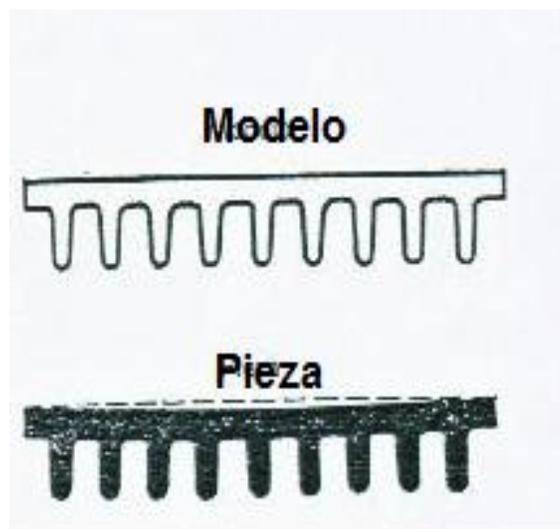
Figura 1.4 Deformaciones que pueden existir en las piezas. [Abramov, 1983]
