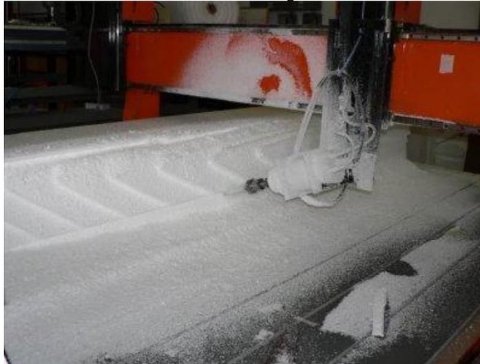
Figura 1.19 Fresadora de control numérico para poliesterol ejecutando cortes.
