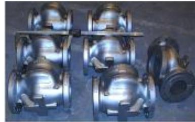
Figura 1.135 Elementos obtenidos mediante el proceso de Fundición por replica.
