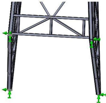
Figura 2.4. Restricciones del tipo `` Geometría Fija`` aplicadas en la base de la estructura
