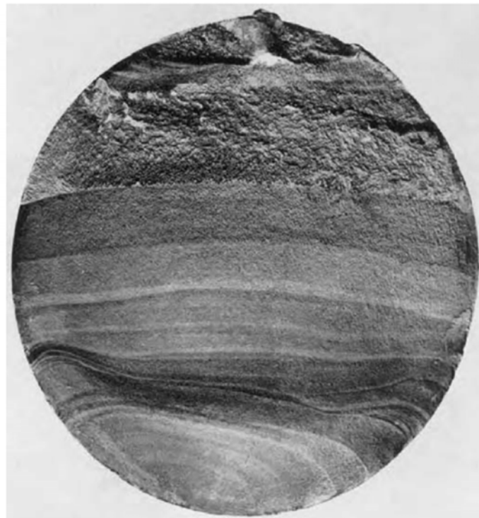
Figura 1.10. Rotura de un eje sometido a flexión con baja tensión nominal.
